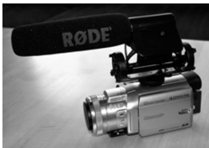
Microfone tipo canhão (shotgun) numa câmera.
